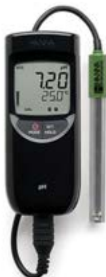
Figure 7 : PH METRES utilisé pour les mesures de qualité des Eaux
